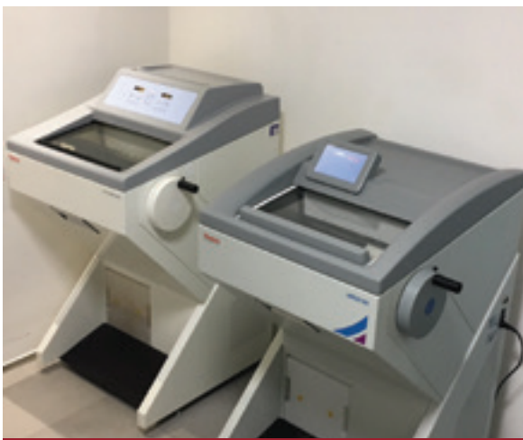
FOTO 1: Criostatos de la Unidad de Oncología Cutánea del Instituto Alexander Fleming. Las capas de Mohs se procesan a -25^{\circ} a -28^{\circ} C.
