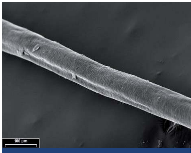
FOTO 2. Microscopia electrónica de barrido: canales a nivel longitudinal con configuración triangular (100 µm).
